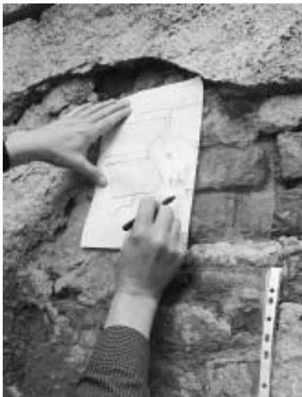
68. Měření profilace architektonických článků a dalších prvků je nejsnáze proveditelné pomocí obrysové šablony s posuvnými jehlami (tzv. hřeben). Výsledek je vysoce přesný, a přitom dosažitelný s minimálními časovými nároky (což je právě při akci OPD žádoucí). Foto: J. Veselý, 2005.
