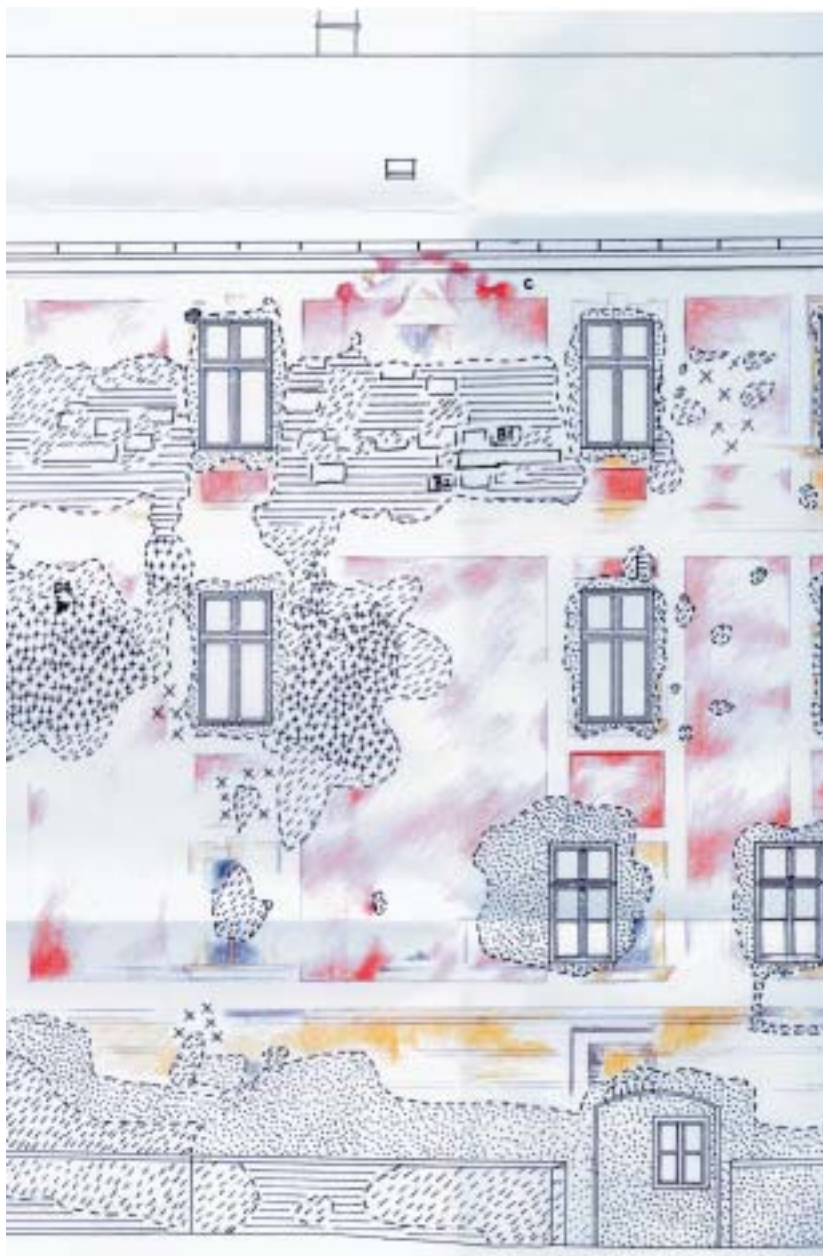
21. Zakreslení zjištěných pozůstatků barevného řešení do zaměření fasády. Javorník (okres Jeseník), zámek Jánský Vrch. T. Vítek, 2005.
