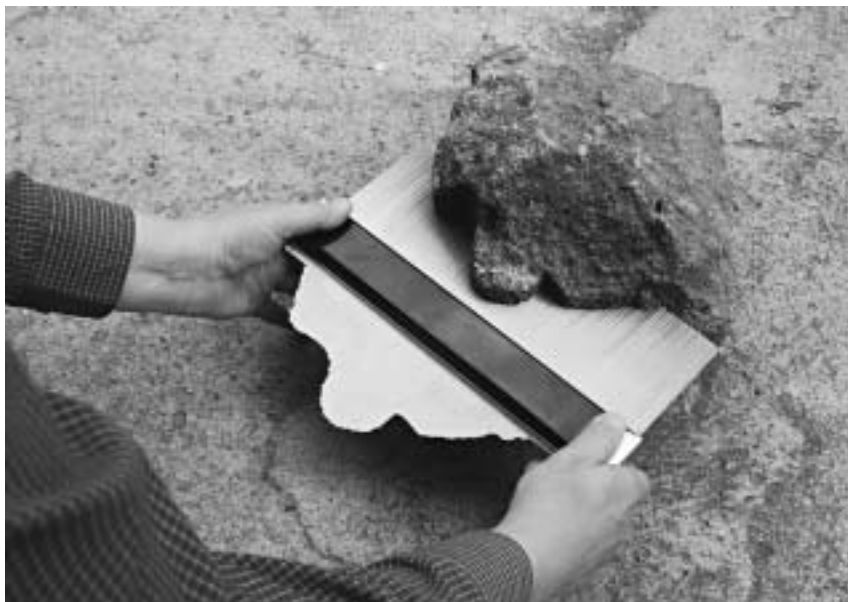
68. Měření profilace architektonických článků a dalších prvků je nejsnáze proveditelné pomocí obrysové šablony s posuvnými jehlami (tzv. hřeben). Výsledek je vysoce přesný, a přitom dosažitelný s minimálními časovými nároky (což je právě při akci OPD žádoucí). Foto: J. Veselý, 2005.
